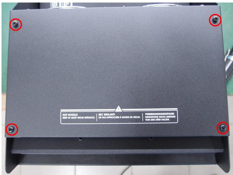
步驟 1. 拆下 F-1 機器上方的四個螺絲。
