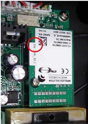
步驟 7. 將 W-DMX 板安裝至主 PCB 上後鎖緊，即完成 W-DMX 天線與主板的安裝。
