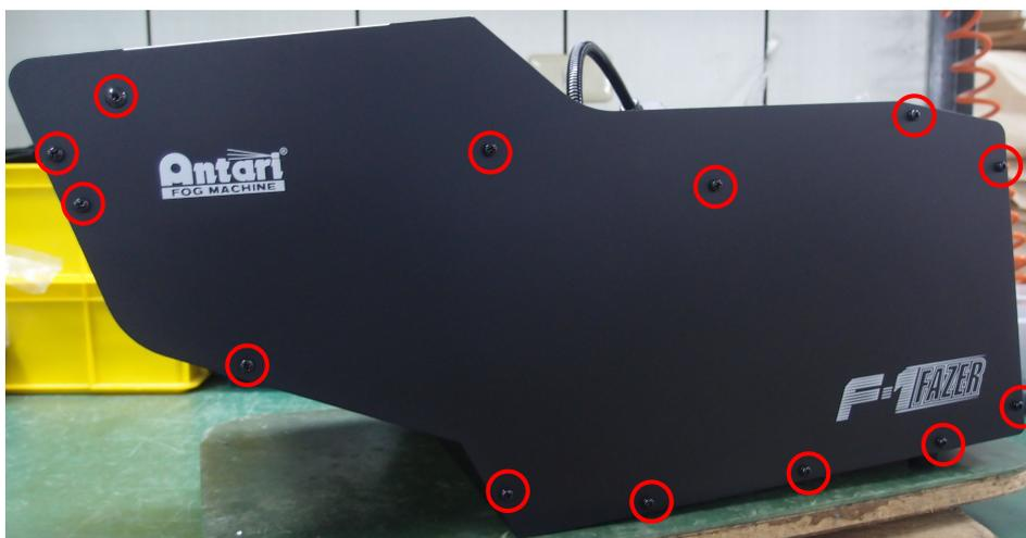
步驟 2. 拆下 F-1 機器側面的 13 個螺絲。
