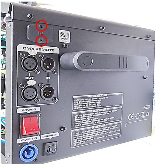
**Schritt 3. Entfernen Sie die Abdeckung.**
