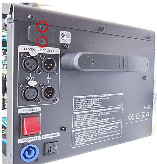
步驟 3. 拆下機身後方的天線檔板.
