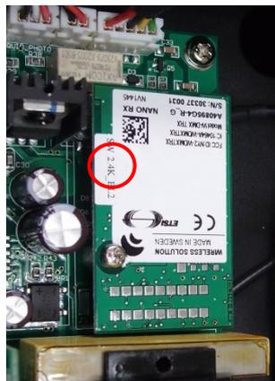
**Etape 7 : Installez le W-DMX sur la platine principale, puis vissez les vis. L'installation est terminée.**
